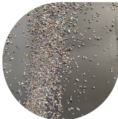
Zu separierendes Material auf dem Förderband des Eddy Current Separators
